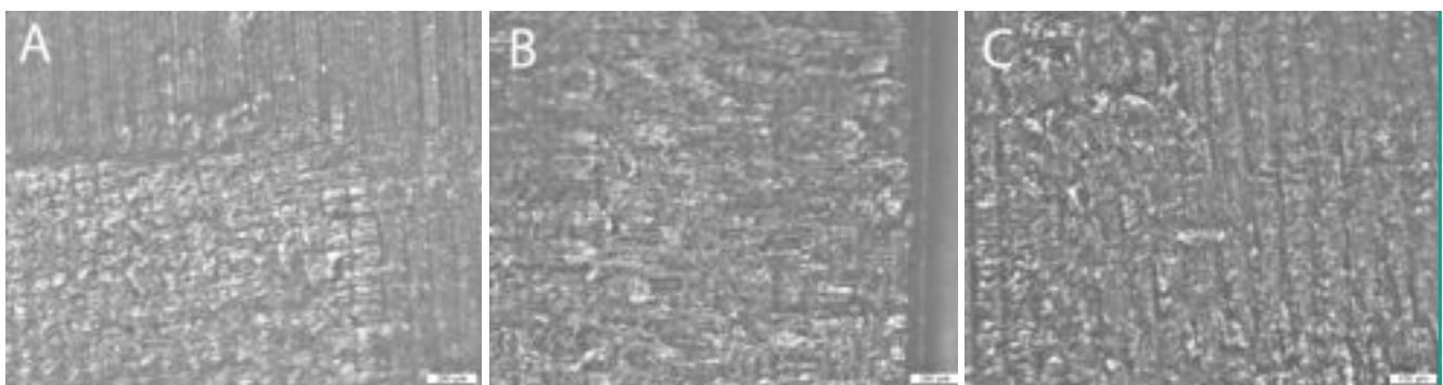
Abb. 2: Lichtmikroskopbild von revidierten PE-Inlays; A) Grad 0: ausschließlich Drehrillen und Abdruck der Pfanneninnenfläche; B) Grad 1: Drehrillen und axiale Kratzer; C) Grad 2: Drehrillen und radiale Kratzer.
